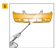
Vorderseite des Kunststoffteils mit einem Hochdruckreininger reinigen.
