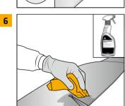
Gesamte Oberfläche mit Sika® Cleaner G+P reinigen und vollständig trocknen lassen.
