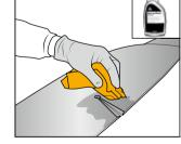
Eine dünne Schicht SikaForce®-300 Primer auf beiden Seiten aufsprühen und 5 Minuten ablüften
