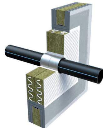
Abschottung von brennbaren Rohrleitungen in SikaSeal Weichschotts ABL und INT.
