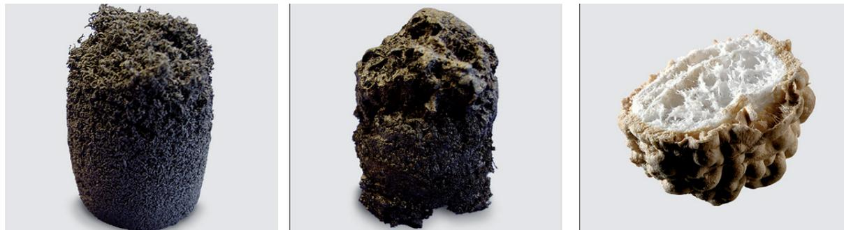
Hoch intumeszierende, feuerfeste Umhüllung von links nach rechts: Graphitbasierte Lösung, phosphatbasierte Lösung und silikatbasierte Lösung
