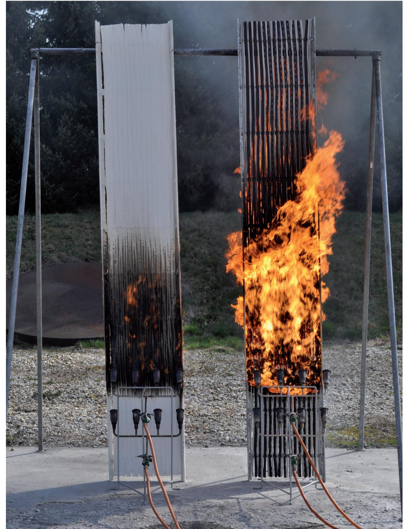
Durchführung eines Brandtests einer hoch intumeszierende, feuerfesten Kabelbeschichtung
