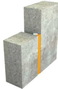
PE-Hinterfüllstab und feuerfeste Dichtungsmasse
