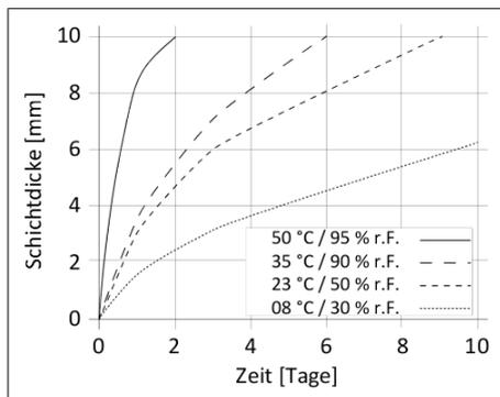
Diagramm 1: Durchhärtegeschwindigkeit Sikasil® WT-65
