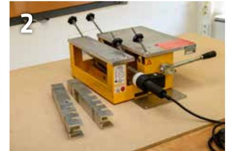
Nur geeignete Schweißgeräte mit teflonbeschichtetem Schweißspiegel verwenden. Der Schweißspiegel des Schweißgerätes muss auf 240°C eingestellt sein. Schweißspiegel vor der Schweißung vollständig aufheizen lassen.
