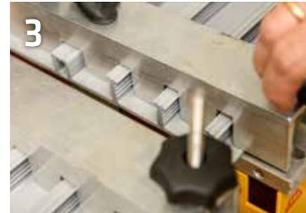
Für das Einspannen der Fugenbandprofileenden in die Halteinrichtung des Schweißgerätes sind ausschließlich passgenaue Klemmschienen für das jeweilige Profil einzusetzen.
