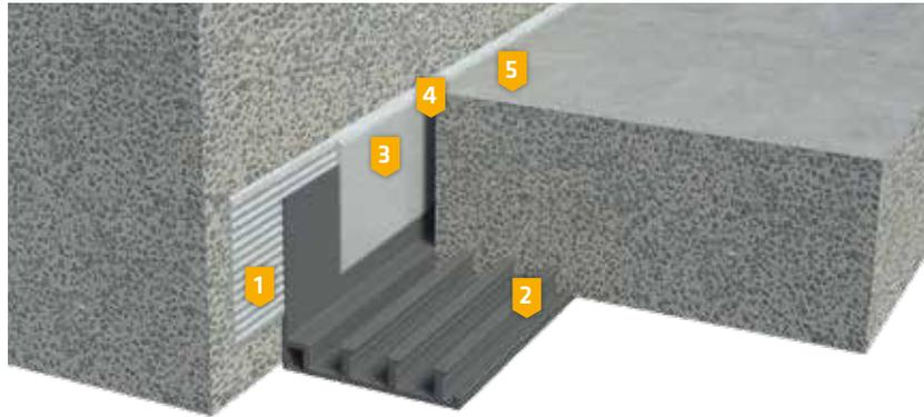
1. Grundauftrag **Sikadur-Combiflex® CF Kleber**, 1-2 mm
