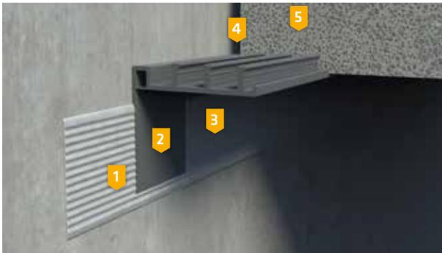
1. Grundauftrag **Sikadur-Combiflex® CF Kleber**, 1-2 mm
