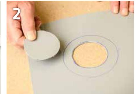
Schneiden Sie den kleineren Kreis mit einer Schere aus. Achten Sie dabei auf saubere Schnittkanten. Rauen Sie den markierten Überlappungs-/Schweißbereich mit Schleifpapier an.
