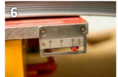
Erste Phase ist die Angleichphase: hierzu die Bandenden unter 10 kg Druck für ca. 5-10 Sekunden angleichen.
