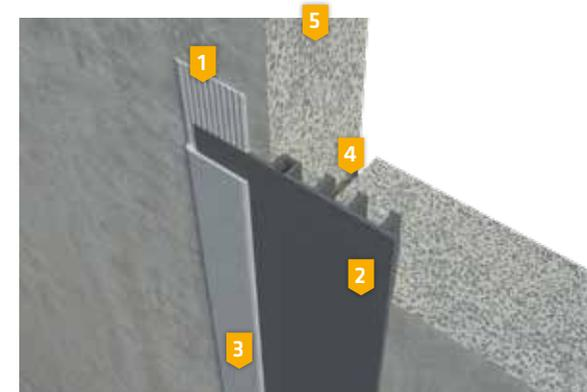
1. Grundauftrag **Sikadur-Combiflex® CF Kleber**, 1-2 mm
