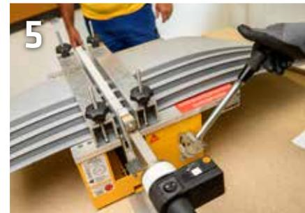
Schweißspiegel einfahren und die Profilenen gleichmäßig unter Druck anschmelzen. Das Anschmelzen erfolgt in zwei Phasen.
