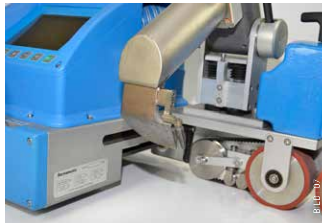
Die zwei Meter breiten Sarnafil-Abdichtungsbahnen werden auf der Mineralfaserdämmung lose verlegt und mit einem Sarnamatic-Schweißautomaten untereinander thermisch verklebt.
