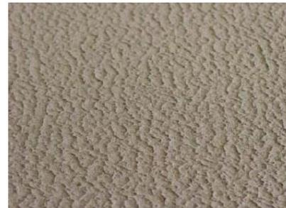
Mechanische Verkrallung mit dem erhärtenden Frischbeton aufgrund der Oberflächenrauheit
