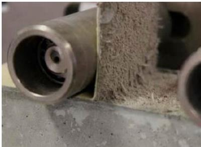
Adhäsion der Verbundschicht aufgrund spezieller polymerer Kunststoffmischung
