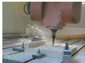
CNC-Fräsen eines leichten PUR-Blocks
