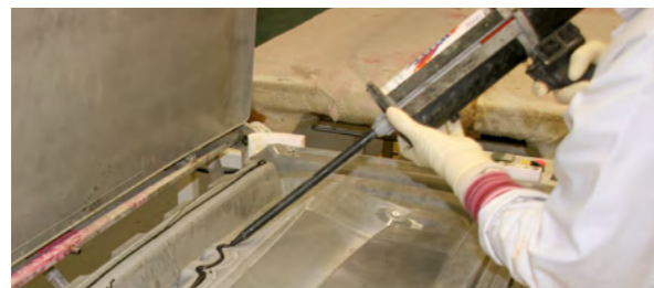
Verklebung von SMC-Teilen mit ADEKIT A280.
