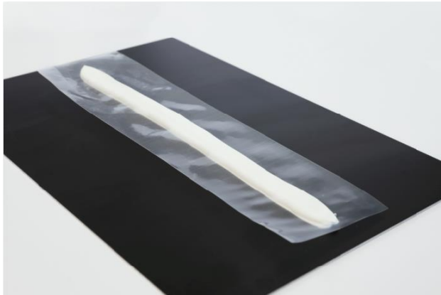
Bild 3: Klebstoffraupe auf halbe Höhe herunterdrücken
