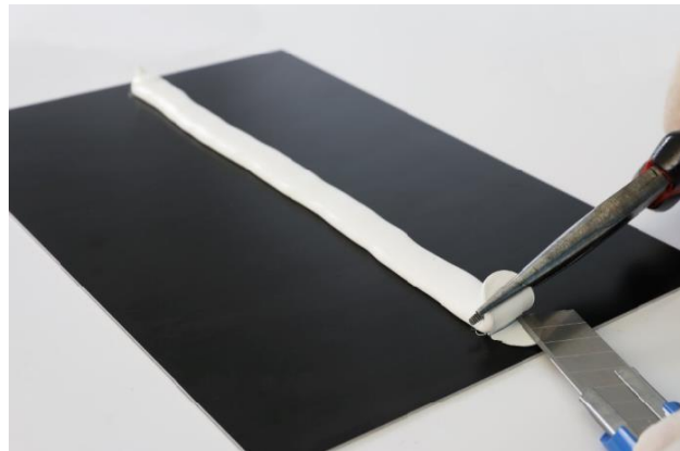
Bild 4: Nach vollständiger Aushärtung die ersten 3 cm der Raupe abtrennen
