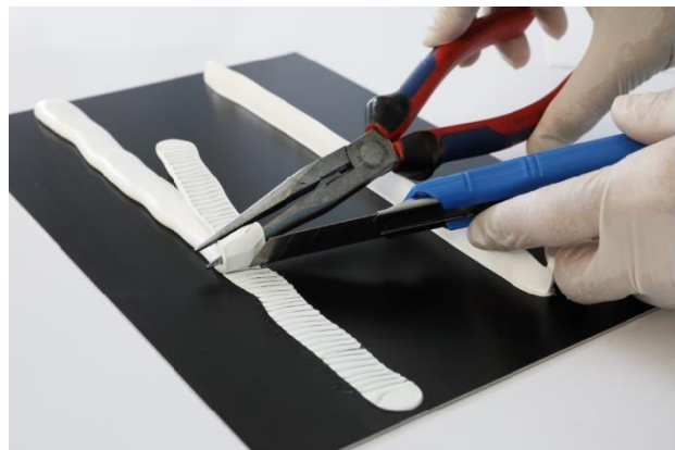
Bild 5: Drehen der Klebstoffraupe, um maximale Spannung und Schnitt zu erhalten
