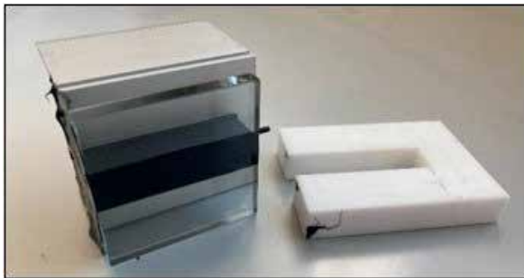
Abbildung 26: Den weißen, U-förmigen Teflon-Abstandhalter nach der entsprechenden Aushärtezeit (siehe oben) entfernen.
