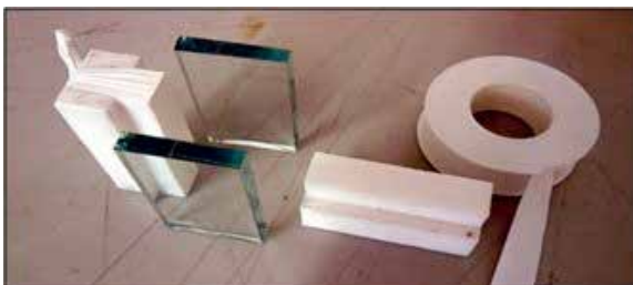
Abbildung 28: Alternative: weiße Teflon-Abstandhalter mit PTFE-Band (nur für 1-komponentige Klebstoffe nötig) und Substrate (z.B. Glas)
