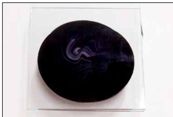
Abbildung 4: Negativer Test = Mangelhafte Mischung
