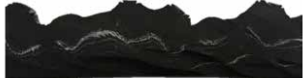
Abbildung 12: Deutliche weisse Streifen im Material, inhomogene Mischung
