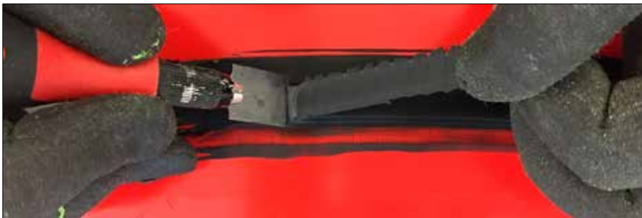
Abbildung 21: Raupenschältest auf emailliertem Glas: Raupe wird unter Spannung eingeschnitten.
