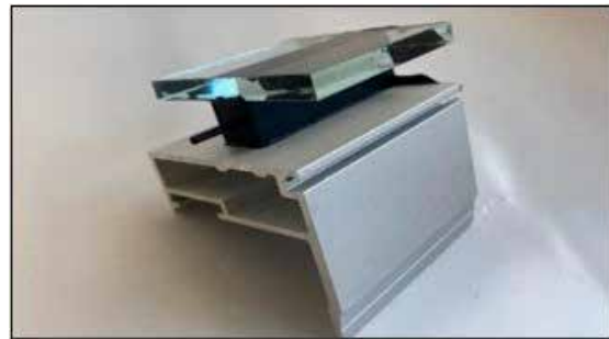
Abbildung 27: H-Prüfkörper (Glas und Aluminiumprofil) für Zugfestigkeitsprüfung, um die maximale Zugfestigkeit zu ermitteln.
