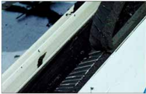
Abbildung 39: Beispiel mit schwarzer SG-Fuge gutes Haftergebnis
