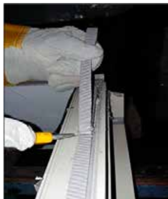
Abbildung 37: Prüfen der Haftung entlang des gesamten Rahmens – Gutes Haftergebnis
