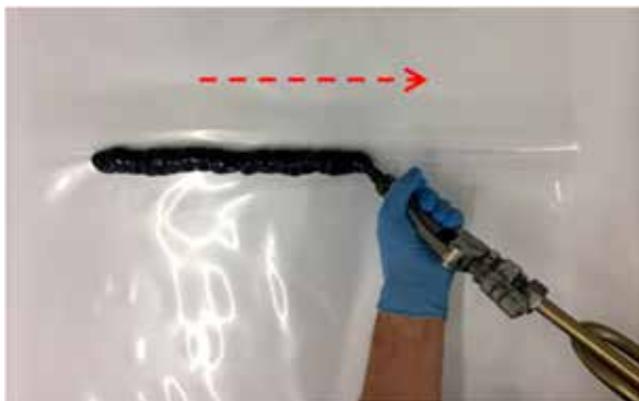
Abbildung 5: Klebstoffraupe auf dem Falz aufbringen
