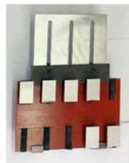
Adapterplatte zur Prüfung von emailliertem Glas
