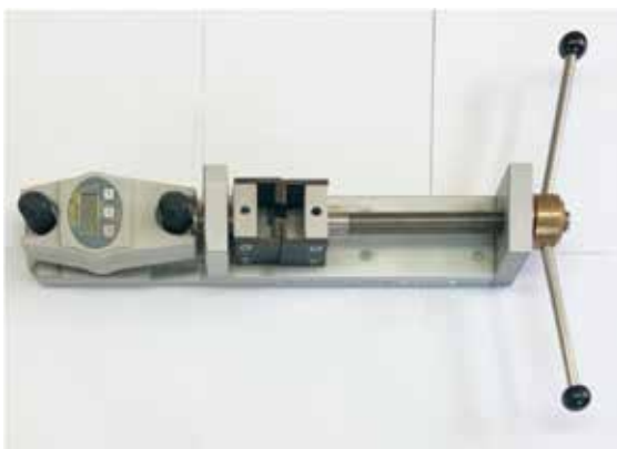
Zugprüfvorrichtung, Fa. ds-mechanic
