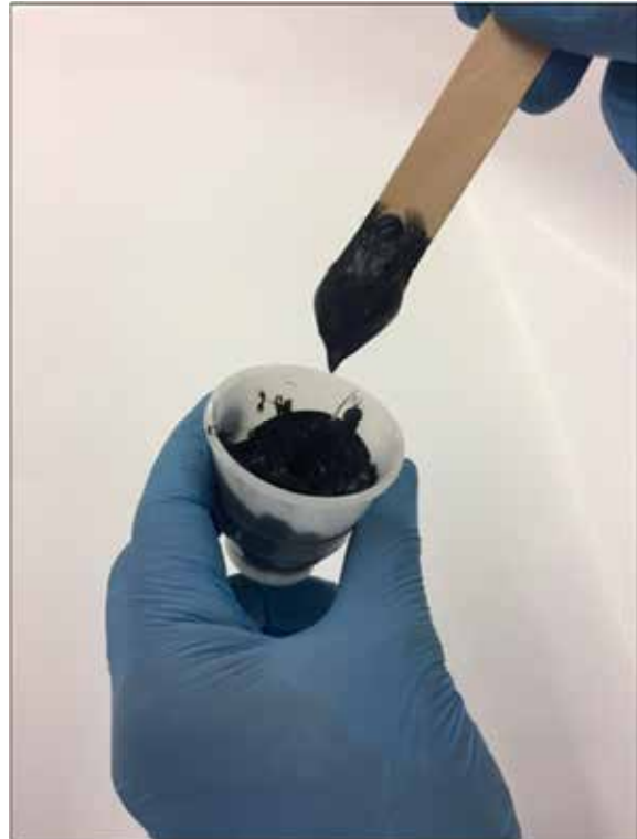
Abbildung 14: Das Material zeigt gummiähnliches Verhalten: Die Topfzeit ist erreicht.
