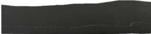
Abbildung 11: Weisse Streifen im Material, inhomogene Mischung
