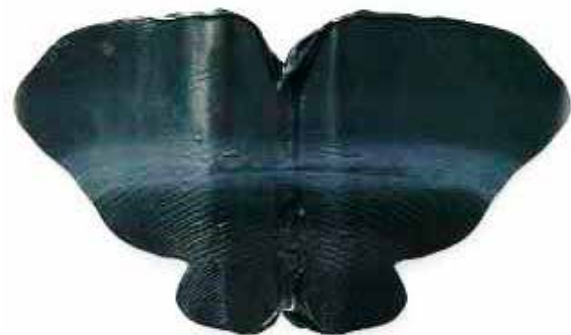
Abbildung 8: negativer Test = ungenügende Mischung
