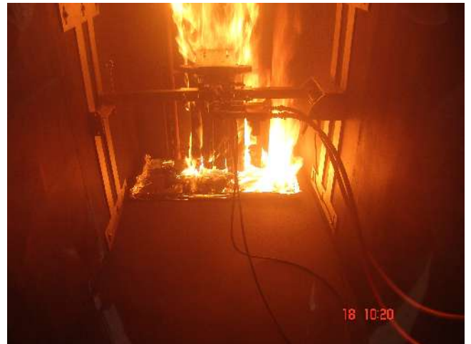
Bild 6: Brennendes Abtropfen Figure 6: Burning droplets
