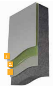
1. Grundierung: Sika® Bonding Primer 2. Zwischenschicht: Sikagard®-403 W + Sika® Reemat Premium/Lite (optional) 3. Deckbeschichtung: 2 x Sikagard®-405 W
