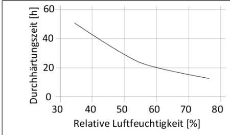
Diagramm 1: Durchhärtezeit für einen 500 µm Klebstofffilm
