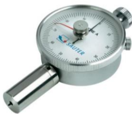
Prüfgerät zur Messung der Shore Härte A
