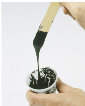
Material zeigt pastöse Eigenschaften: Topfzeit noch nicht erreicht. (Hilfsmittel Eieruhr oder Handy mit Weckfunktion)
