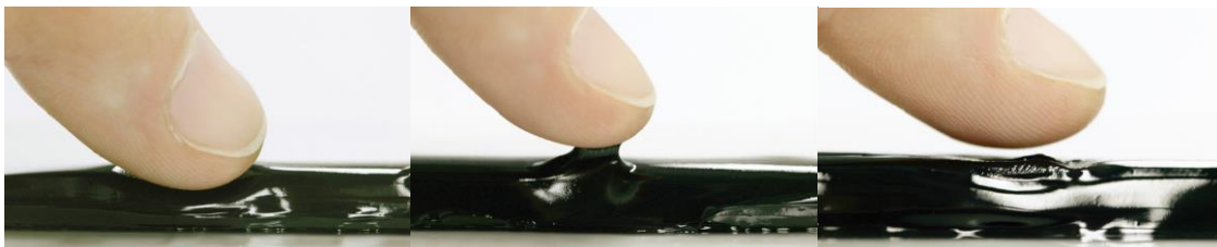
Die Fingerspitze leicht auf den Klebstoff drücken und wieder wegziehen. Die Hautbildezeit ist erreicht, wenn der Klebstoff nicht mehr am Finger haften bleibt (Bild rechts).
