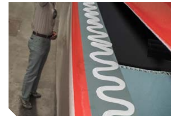
Sikaflex®-292i wird dickschichtig auf die Verbindungsfläche aufgetragen
