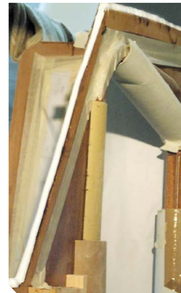
Sikaflex®-292i auf einer Leichtbauplatte vor der Verklebung
